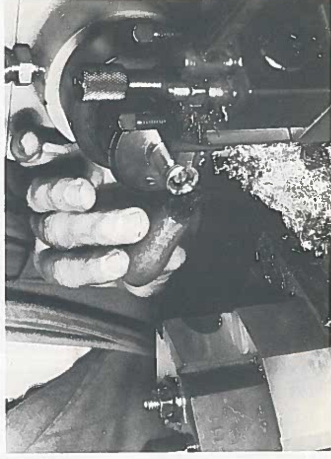
Diamantage latéral d'une alliance. L'opération permet d'obtenir une surface absolument parfaite.
